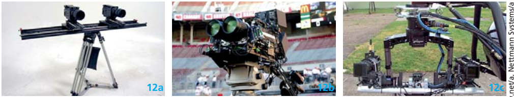
Abb. 12 – Side-by-Side-Rigs: a) Montage auf einem Schlitten; b) Espn-3D-Rig ; c) Hyperstereo-Rig DaVinci von Nettmann-Systems, vor einem Hubschrauber montiert.
