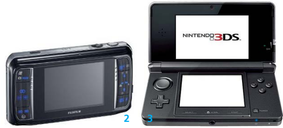
Autostereoskopische Wiedergabe: 1 zylindrische Linsen im Schema; Beispiele für Endgeräte sind 2 Fuji Cinepix Real 3D W1 und 3 Nintendo 3DS.
