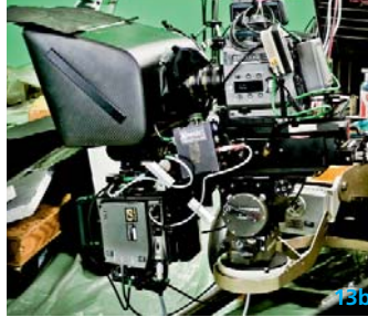
Abb. 13 – Spiegel-Rigs: a) 3reality-Rig; b) Swissrig; c) Binocle-3D-Rig mit zwei SI-2K-Kameras.
