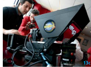
Abb. 13 – Spiegel-Rigs: a) 3reality-Rig; b) Swissrig; c) Binocle-3D-Rig mit zwei SI-2K-Kameras.
