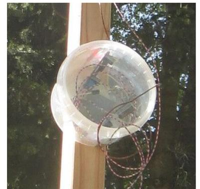
5. Peg (mit Laufrad) auf den Mast setzen, Stifte in die Löcher einführen und ggf. mit Klebeband abkleben. Loch buddeln und Mast aufstellen.
