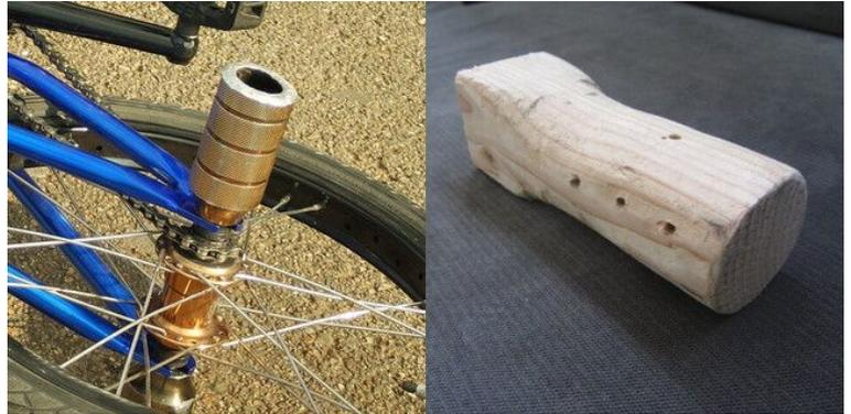
3. Peg an die Laufradachse schrauben: Achse, Unterlegscheiben, Peg, Mutter aufeinander stecken, mit einer langen Flachzange etwas zuschrauben, und anschließend mit dem Schnellspanner festziehen. Das Peg und die Laufradschraube müssen fest verbunden sein und dürfen sich nicht gegeneinander verdrehen lassen.
